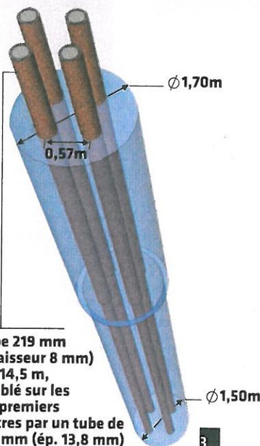
Tube 219 mm (épaisseur 8 mm) sur 14,5 m, doublé sur les 6,5 premiers mètres par un tube de 273 mm (ép. 13,8 mm)
